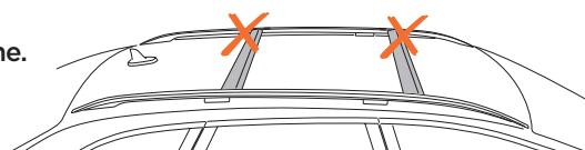
**N'utilisez PAS de tentes Tepui sur des barres transversales installées en usine.**
