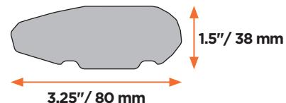
**Les tentes Tepui conviennent aux barres transversales ayant une largeur maximale de 80 mm/3,25 po et une hauteur de 38 mm/1,5 po.**
